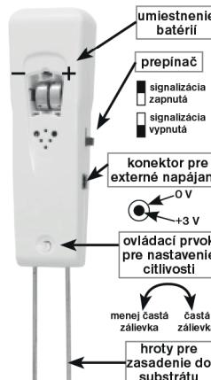
Napájanie 2x 1,5V alkal. batérie, typ LR44. Stupeň krytie IP20.
