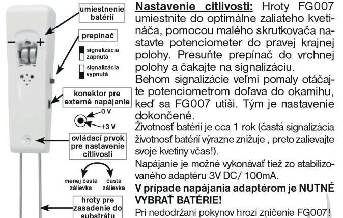
Napájanie 2x 1,5V alkal. batérie, typ LR44. Stupeň krytie IP20.
