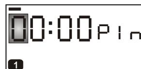
Pokud PIN kód zadaný v termostatu nesouhlasí s PIN kódem karty v modulu, začne blikat na displeji do 3 minut chybové hlášení (Err: P). Musí následovat odpojení modulu od termostatu, následně RESET termostatu (viz. návod PT30, str.7). Postup zadání PIN kódu je nutné zopakovat a poté provést připojení modulu k termostatu a přes napájecí zdroj do el.sítě 230V/50Hz.
