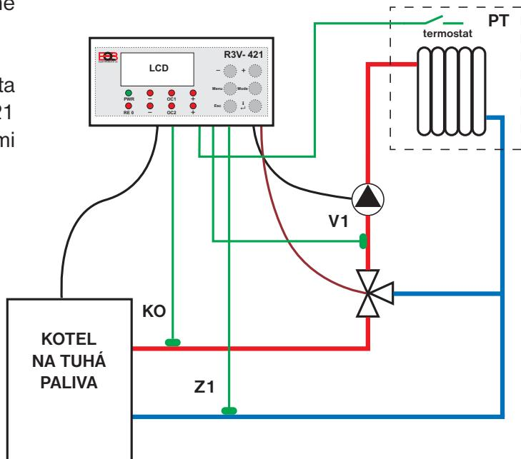
**!** Pozn.: Schéma je pouze ilustrativní, neřeší hydraulické a bezpečnostní prvky celého systému, ty musí být instalovány v souladu s danými předpisy pro instalaci ústředního vytápění!
