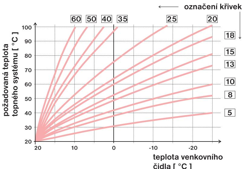
**Principem ekvitermní regulace s dorovnáním je** optimalizace teploty vody topného systému v závislosti na venkovní teplotě a na aktuální teplotě v místnosti. Tuto závislost vyjadrují uvedené ekvitermní křivky (pro požadovanou teplotu místnosti 20°C), podle kterých volíme požadovanou teplotu vody topného systému.
