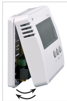
Obr.4 Nasadíte diel s elektronikou na spodnú časť a zaistíte aretačnou skrutkou.
