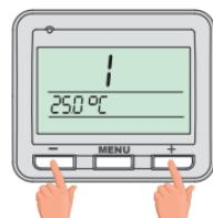
Tlačidlami + / - nastavte príslušnú hodnotu a potvrdte tlačidlom MENU.
