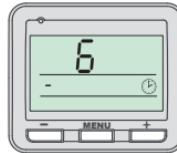
Tlačidlami / nastavte príslušnú hodnotu a potvrďte tlačidlom **MENU**.
