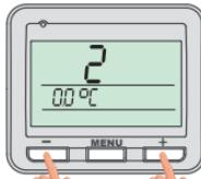
Tlačidlami **+ / -** nastavte príslušnú hodnotu a potvrdte tlačidlom **MENU**.
